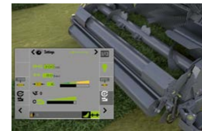
La alimentación hidráulica se deja ajustar cómodamente desde el asiento del tractor.
