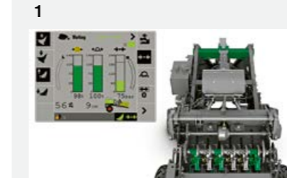
El reglaje automático de la presión de empacado mide y visualiza la carga en el marco de la empacadora y los anudadores.
