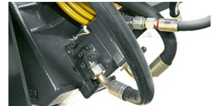
Dos bombas de aceite abastecen el engranaje de entrada y el sistema de limpieza del anudador TURBO FAN con aceite hidráulico.
