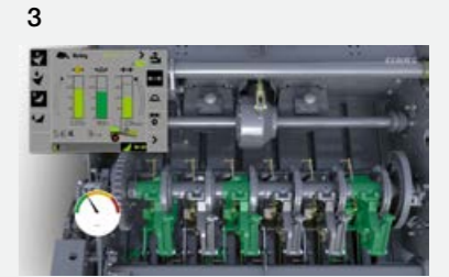
Para el reglaje automático de la presión de empacado están montados tres sensores en los anudadores. Éstos emiten el segundo valor de reglaje.
