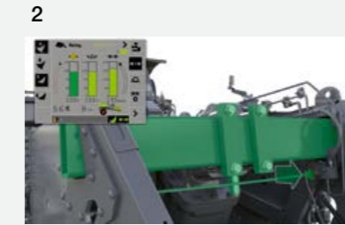
El sensor en el marco de la empacadora define uno de los dos valores de reglaje. La carga es mostrada al operario en su terminal de mando.
