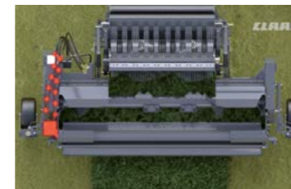
Pickup, PFS y repartidor de rodillos se encargan de un flujo óptimo.
