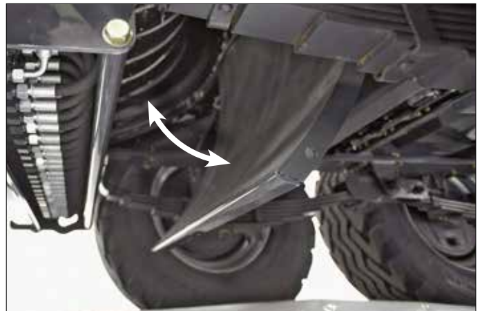
Compuerta de inspección de la cámara de precompresión
