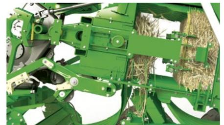
**3** Esto empuja el material pre comprimido hasta el interior de la cámara de prensado para ser compactado por el pistón hasta formar una paca realmente densa.
