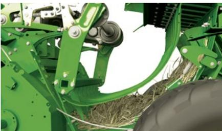
**1** La horquilla transporta el material desde el rotor en línea hasta la precámara para producir un aglomerado de material de densidad homogénea.
